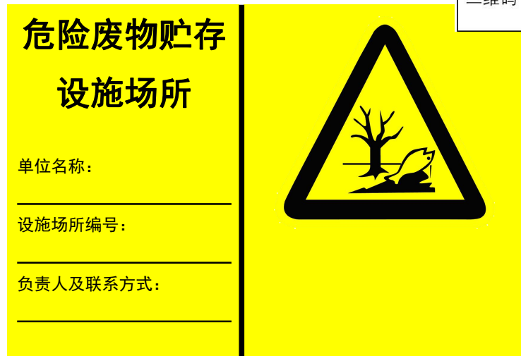
图 5 危险废物贮存设施场所标志牌
