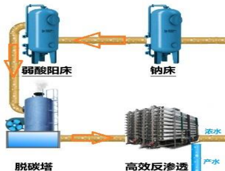
图 11.2.5-14 高效反渗透工艺流程
